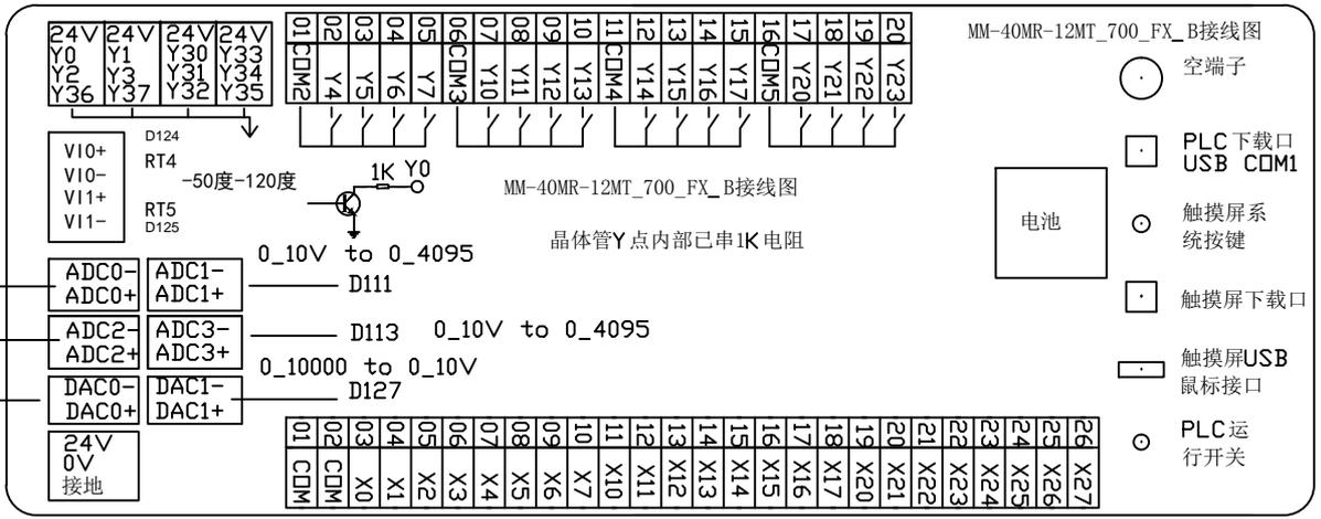
输入属于NPN型，不需要外接电源，直接短接COM和X点即可
