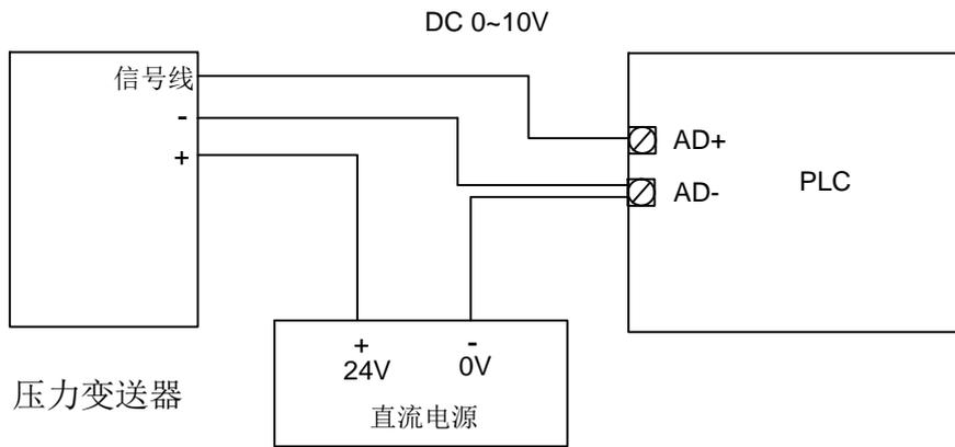
0~10V压力变送器与PLC接线图（3线制）
