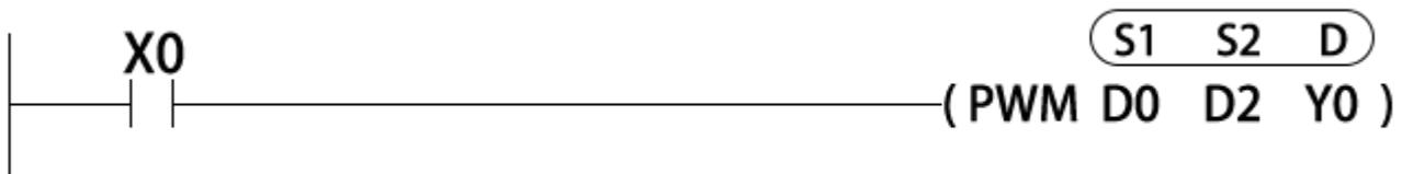
\*S1--PWM 指定的频率, 32 位数 (Y0-Y3 最高 900KHz, 超出报 6706);
